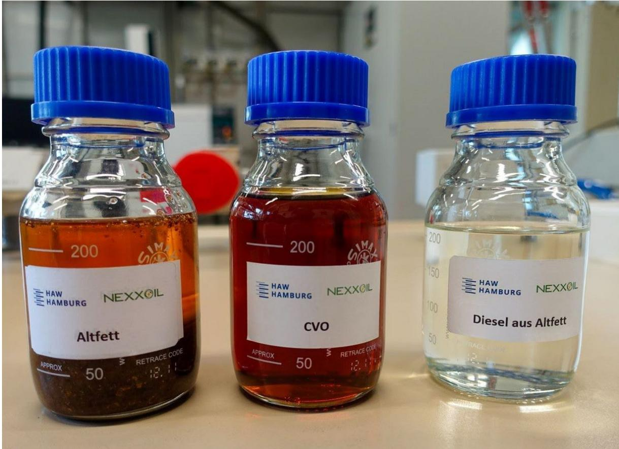
In dem in Hamburg entwickelten neuen Verfahren wird in einem zweistufigen Prozess aus verunreinigtem Alt fett ein Bio-Öl destilliert und anschließend ein hochwertiger, reiner Dieseldieselkraftstoff erzeugt. (Alle Fotos: C. Schneider / DMYV)
